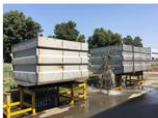
水罐静水压试验
